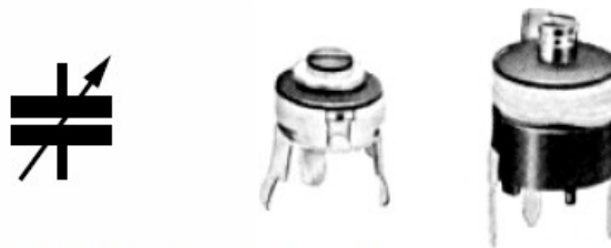
Fig.74 Simbolo grafico di un compensatore. La freccia posta sul simbolo indica che la sua capacità è variabile.
