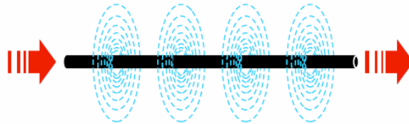
Fig.212 Facendo scorrere una tensione in un filo di rame attorno a questo si creano dei deboli flussi magnetici.
